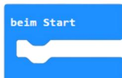
Läuft **einmal** wenn der micro:bit gestartet (angeschlossen) oder der Reset-Knopf gedrückt wird.
