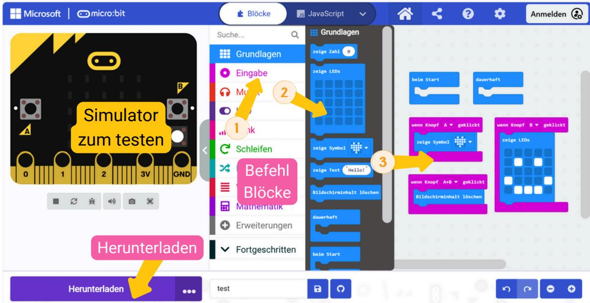
**Wichtig:** Bei jedem Herunterladen eines Programmes wird das alte Programm im micro:bit völlig ersetzt.
